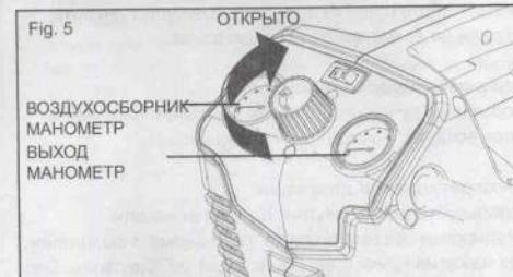
**ПРИМЕЧАНИЕ.** Воздушный компрессор автоматически запустится после того, как давление в воздухосборнике опустится ниже минимального заданного значения (давления включения).
