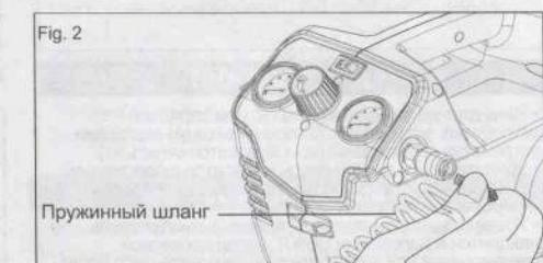
**ПРИМЕЧАНИЕ.** При подключении или отключении воздушного шланга удаляйте воздух из воздухосборника.
