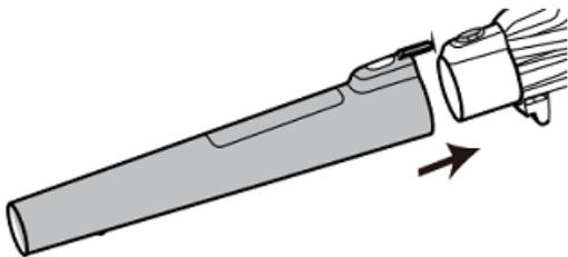
**Примечание:** Перед запуском устройства убедитесь, что труба воздуходувки надежно закреплена на патрубке.
