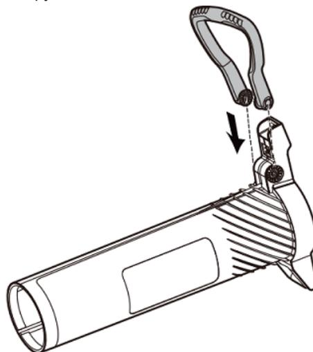
3. Вставьте болт через отверстие так, чтобы он прошел через обе стороны вспомогательной ручки, и закрепите с помощью ручки-зажима.
