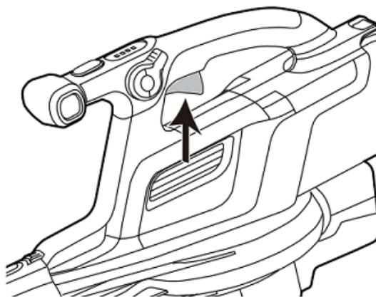
2. Курок-выключатель обеспечивает более высокую скорость воздушного потока при увеличении давления на него и более низкую скорость при уменьшении давления.
