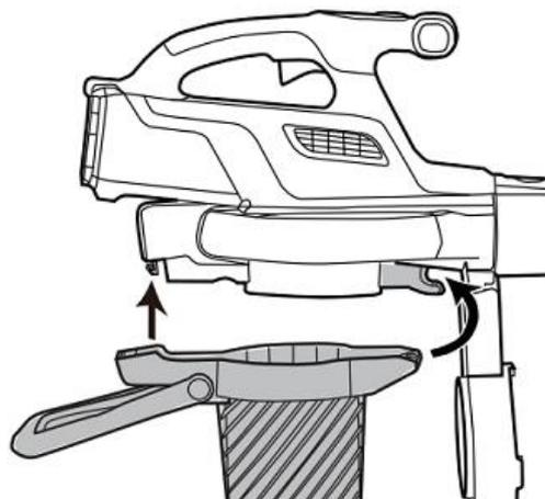
4. Установите корпус трубы пылесоса до щелчка кнопки разблокировки заглушки.
